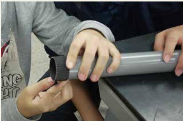
圖 11 放入鏡片後，內部再纏繞一圈細的瓦楞紙
