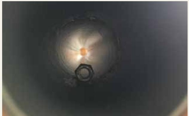
圖 16 在水管內黏上小螺帽，可以避免目鏡鏡筒放置時滑入
