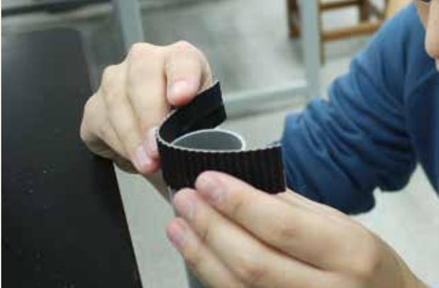
圖 10 將粗的瓦楞紙環繞於水管，並留 1~1.5 公分在管口外
