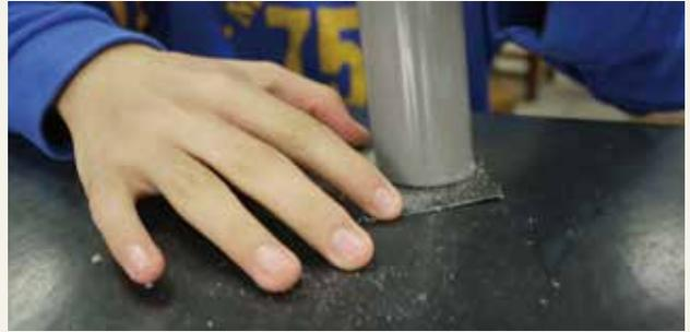
圖 7 利用砂紙可將水管磨平整又光滑
